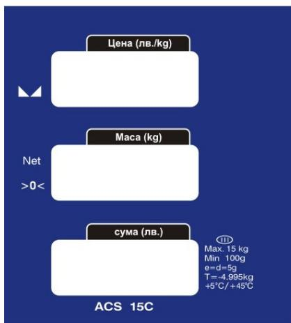
На дисплея **Маса (kg)** се появява автоматично масата на предмета, поставен на платформата, в границите на допустимите 15 kg (30kg), включително тарата. Проверочното деление е 5 g. При пускане везната проверява наличието на платформата и взема предвид нейната маса при по-нататъшните претегляния. На дисплея се появява **0** и показателят **>0<** светва. Избягвайте да поставяте рязко
